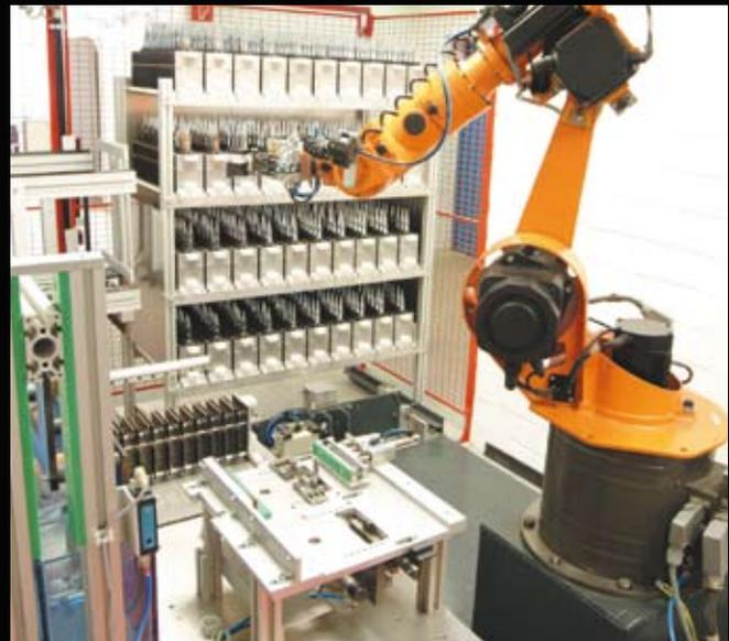
Toutes les pinces sont contrôlées individuellement au moyen de robots dans un bain d'eau à une tension de 10000 V.
