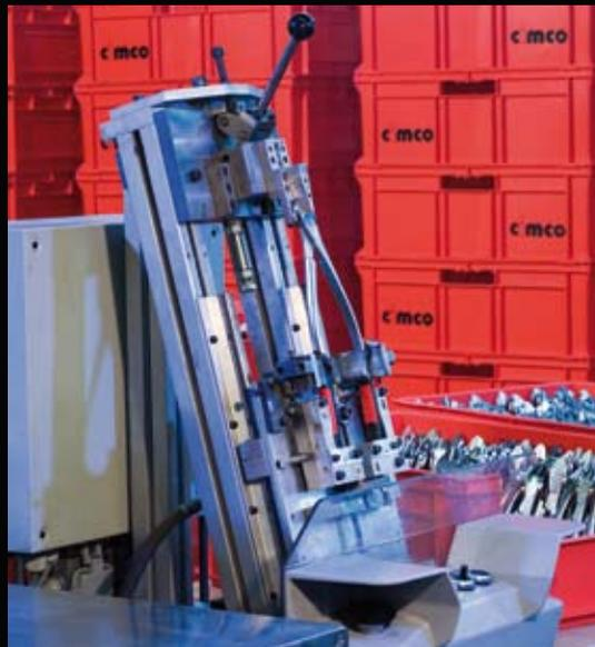
En ayant recours à des dispositifs de montage spéciaux, ensemble avec des doseurs de colle, une adhérence optimale entre les branches et l'ébauche de la pince est garantie.
