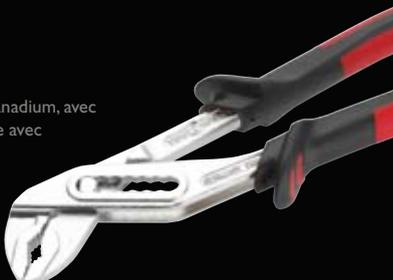
**Branches en plastique bicolore, isolées par immersion et garantissant une sécurité optimale. En cas d'endommagement de la couche d'isolation extérieure rouge, la couche de couleur orange devenue visible signale que la sécurité n'est plus garantie à 100 % conformément aux normes de sécurité en vigueur.**
