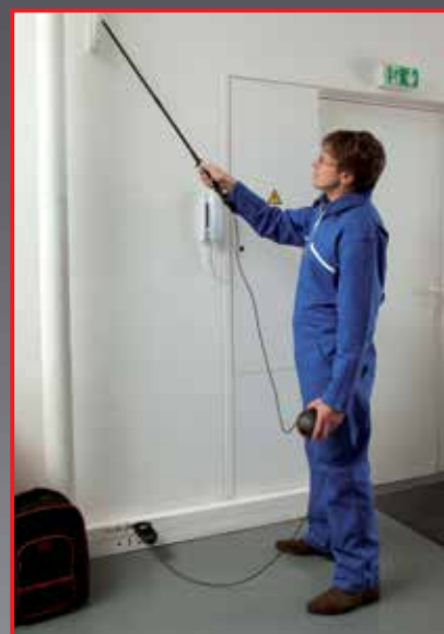
Contrôle de continuité sur masse métallique en hauteur avec perchette de contact longueur 0,8 m (réf. M-951143) raccordée à la pointe de touche sur prolongateur.
